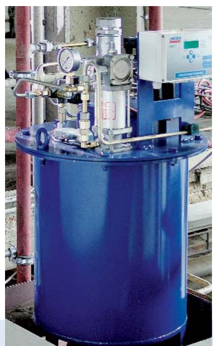
Estación de bombeo completa con control integrado.
